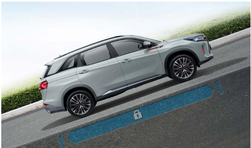
**Control de Estabilidad Electrónico (ESP).** Al detectar situaciones de riesgo, el ESP interviene automáticamente, aplicando frenos individualmente y ajustando la potencia del motor para mantener el vehículo en la trayectoria, mejorando así la seguridad y el control.
