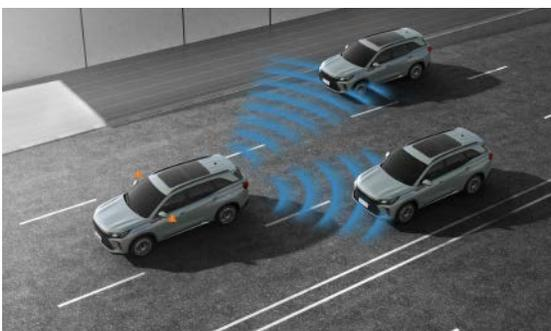
**Detector de punto ciego (BSD).** Si se detecta un vehículo en el punto ciego del conductor, el sistema alerta al conductor mediante una señal en el espejo lateral derecho o izquierdo.
