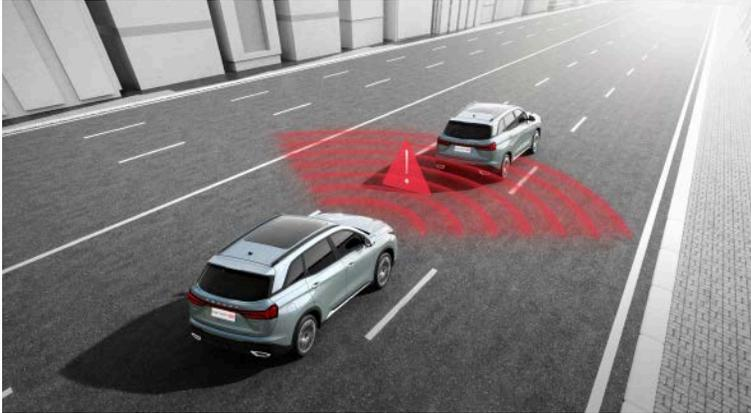
**Sistema de Alerta de Frenos de Emergencia (ESS).** El DFSK 600 detecta situaciones de frenado repentino y activa las luces de emergencia para alertar a los conductores detrás de ti.
