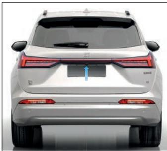
El vehículo con sistema de imagen de marcha atrás está equipado con una cámara situada encima de la matrícula trasera.
