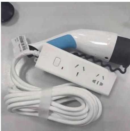
Al utilizar el enchufe de carga lenta y la pistola de descarga, el vehículo puede generar energía de 220 V CA, actuando como fuente de energía para suministrar electricidad a electrodomésticos como iluminación, hornos de baja potencia, etc. La potencia máxima de salida puede alcanzar los 3,3 kW.
