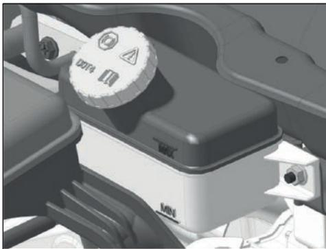
Verifique el nivel del líquido de frenos durante el período de mantenimiento especificado. Si desea comprobarlo, estacione el vehículo en una superficie nivelada. Después de que el vehículo se enfríe, abra la tapa del depósito de líquido de frenos.
