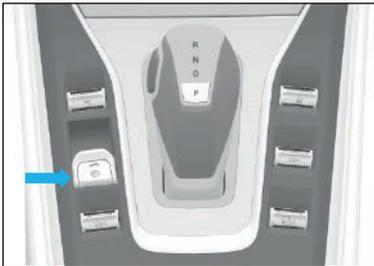
Cuando el vehículo se detiene, después de tirar hacia arriba el botón del interruptor EPB, se aplica el freno de estacionamiento, se enciende la luz indicadora de estacionamiento del instrumento 'P' y se enciende la luz LED en el botón del interruptor EPB.
