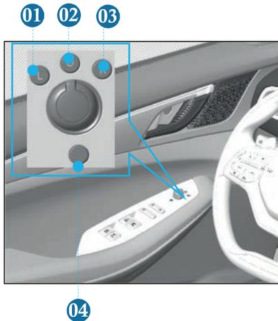
1. Ajuste del espejo retrovisor exterior: Gire el interruptor al selector ❶ o ❸ (Izquierdo o Derecho). Mueva la perilla de ajuste para ajustar los ángulos superior, inferior, izquierdo y derecho de la lente del espejo retrovisor exterior.
