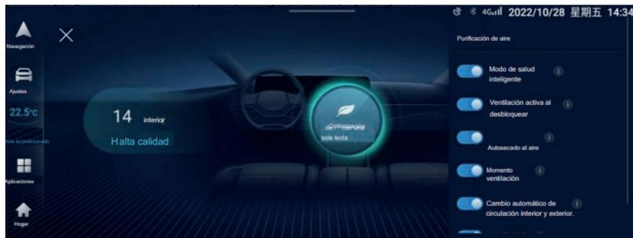
Cuando el modo de salud inteligente está activado, el controlador de aire acondicionado activará todas las funciones de salud inteligente de forma predeterminada. Las funciones relevantes se pueden configurar según las necesidades del usuario para eliminar el olor en el vehículo antes de subir al vehículo y respirar aire fresco.
