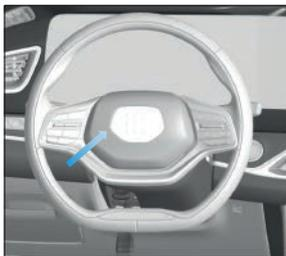
Para hacer sonar la bocina, presione la cubierta central del volante.
