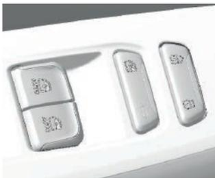
Para evitar que los pasajeros utilicen accidentalmente los interruptores de las ventanas del automóvil, presione el interruptor de bloqueo de las ventanas. Cuando la luz indicadora esté encendida, los interruptores de las ventanas del pasajero se desactivarán y no funcionarán. Para desbloquear los interruptores de las ventanas del pasajero para controlarlos, presione el interruptor de bloqueo de las ventanas nuevamente hasta que se apague la luz indicadora.
