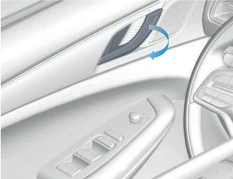
Bajo la condición de todo. Mientras el vehículo está bloqueado, puede abrir la puerta del vehículo desde el interior tirando de la manija interior de la puerta dos veces seguidas.
