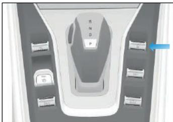
Si se presiona el interruptor ESC OFF durante menos de 10 s, la luz indicadora del instrumento se enciende, indicando que el ESC está cerrado y las funciones TCS y ESC se desactivarán. Al presionar nuevamente el interruptor ESC OFF, la luz indicadora del instrumento se apaga, lo que indica que el ESC se enciende nuevamente.
