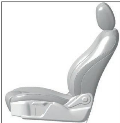
Al ajustar el asiento usando los botones del asiento eléctrico, ajustar el ángulo del respaldo a 25° en dirección vertical se considera la posición de uso normal. Para los asientos con ajuste eléctrico, esto se puede lograr operando los botones de ajuste eléctrico.
