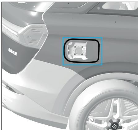
Diagrama esquemático para la ubicación del enchufe de carga lenta del vehículo.
