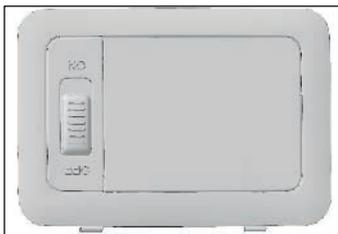
Las luces de lectura traseras están instaladas en diferentes posiciones según las configuraciones. En el caso de una configuración de techo corredizo pequeño, las luces de lectura traseras están ubicadas encima de la parte trasera de los asientos de la segunda fila. En el caso de la configuración de techo corredizo panorámico, las luces de lectura traseras están ubicadas frente a las manijas interiores izquierda y derecha de la segunda fila.
