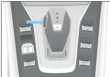
En el estado estacionario del vehículo, presione el pedal del freno y mantenga presionado el botón de desbloqueo mientras mueve la palanca de cambios hacia adelante o hacia atrás para cambiar entre las siguientes velocidades: R (Reversa), D (Conducción) y N (Neutral).
