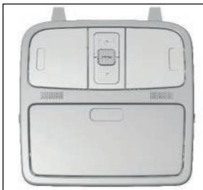
2. Detener: Cuando el techo corredizo está funcionando en modo automático, presionar cualquier botón detendrá inmediatamente el movimiento del techo corredizo.
