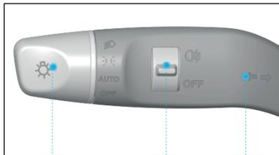
Al ajustar la perilla izquierda en la palanca de ajuste de luces izquierda del volante, puede controlar las luces de posición y los faros.
