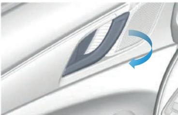
Si el vehículo no tiene electricidad y hay ocupantes dentro, puede desbloquear la puerta tirando de la manija interior de la puerta dos veces seguidas.
