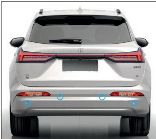
Parachoques trasero: 4 sensores ultrasónicos en el parachoques trasero.
