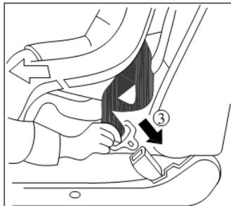
4. Pase la lengüeta del cinturón de seguridad encima del asiento de seguridad para niños e insértela en la hebilla ③ hasta que sienta bloquearse y escuche un chasquido;
