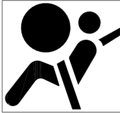
No agregue una cubierta de asiento a los asientos delanteros para evitar que las bolsas de aire laterales no se abran correctamente.
