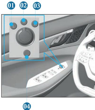
1. Ajuste del espejo retrovisor exterior: Gire el interruptor al selector 01 o 03 (Izquierdo o Derecho). Mueva la perilla de ajuste para ajustar los ángulos superior, inferior, izquierdo y derecho de la lente del espejo retrovisor exterior.
