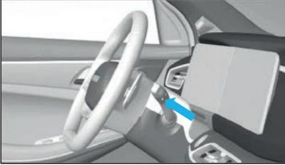
Para operar el lavaparabrisas, tire de la manija del interruptor del limpiaparabrisas hacia arriba (en la dirección de la flecha que se muestra en la ilustración) hasta que se rocíe la cantidad deseada de líquido lavaparabrisas sobre el parabrisas. Luego, el limpiaparabrisas funcionará automáticamente varias veces para limpiar el parabrisas.
