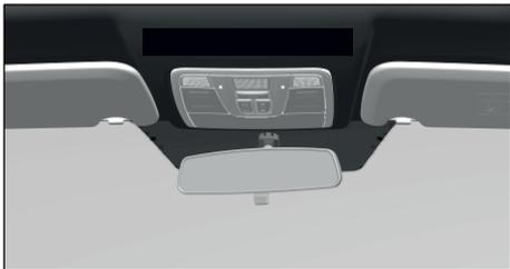
Antideslumbrante manual: tire de la palanca de ajuste debajo del espejo retrovisor interior hacia atrás para activar el modo antideslumbrante; Empuje la palanca de ajuste hacia adelante para desactivar el modo antideslumbrante.
