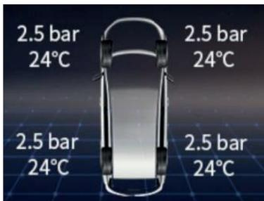
1. Después de arrancar el vehículo, si el vehículo está parado, el grupo de instrumentos mostrará la información específica de la presión de los neumáticos antes de estacionar.
