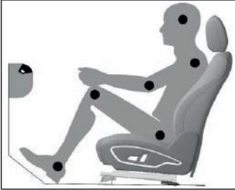
Cuando un pasajero está sentado en el asiento delantero y la velocidad del vehículo es  $\geq 10$  km/h, el sensor de gravedad detecta el peso del pasajero y envía una señal a la pantalla. El automóvil emite una señal sonora continua para recordar al pasajero que se abroche el cinturón de seguridad, durante la cual el panel de instrumentos muestra un indicador parpadeante.
