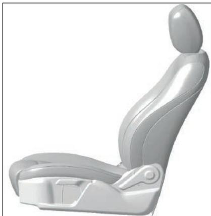
Al ajustar el asiento usando los botones del asiento eléctrico, ajustar el ángulo del respaldo a 25° en dirección vertical se considera la posición de uso normal. Para los asientos con ajuste eléctrico, esto se puede lograr operando los botones de ajuste eléctrico.
