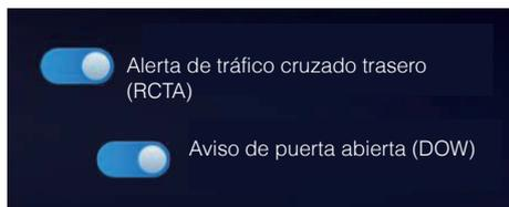
En la pantalla táctil del control central, haga clic en Configuración del vehículo > Asistencia a la conducción > botón Alerta de tráfico cruzado trasero (RCTA). El botón se enciende, lo que indica que la función está activada. El botón aparece atenuado significa que la función está desactivada.
