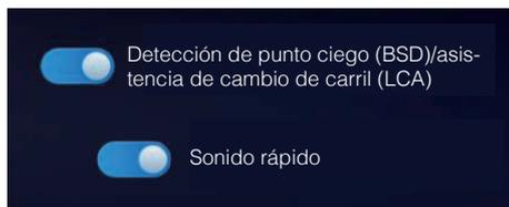
En el panel de control central, haga clic en **Configuración del vehículo.> Asistencia a la conducción.> Botón BSD/LCA**. El botón se enciende, indicando que la función está habilitada. Cuando el botón se vuelve gris, significa que la función está deshabilitada y, al mismo tiempo, se apaga la luz indicadora correspondiente en el instrumento.
