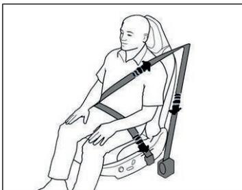
Si los cinturones de seguridad delanteros están equipados con pretensores, funcionan junto con los airbags durante colisiones frontales graves.
