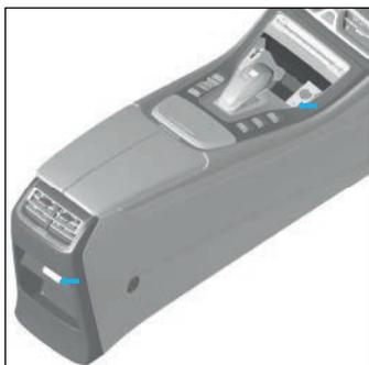
El vehículo tiene dos interfaces de dispositivo USB, una está ubicada en la caja de almacenamiento frontal de la caja de control y la otra está ubicada en la cubierta trasera de la caja de control. La interfaz en la caja de almacenamiento frontal de la caja de control se utiliza para conectar la unidad flash USB y cargar el dispositivo USB. La cubierta trasera de la caja de control se utiliza para cargar el dispositivo USB.
