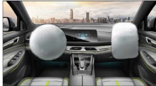
Explosión y despliegue de la bolsa de aire del asiento del conductor y del pasajero delantero
